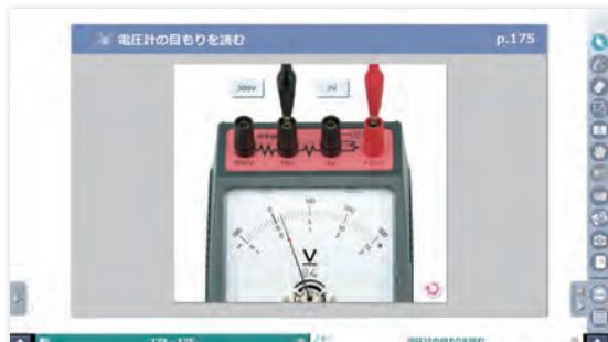
電圧計の使い方の場面で、端子の接続位置を自由に変えることができるシミュレーションです。
